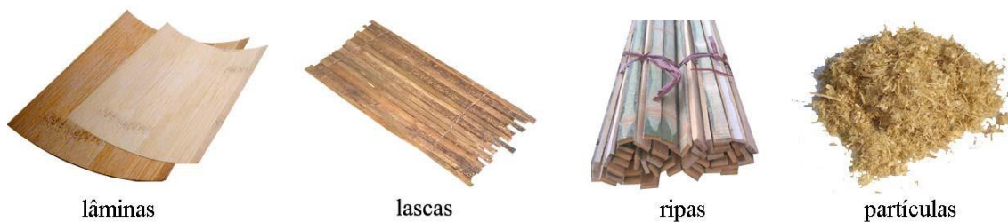
Figura 6 – Lâminas, lascas, ripas ou partículas: amostras de material empregado nos painéis. Fonte: Moizés, 2007.
